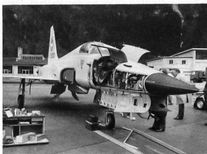
Der Tiger zeigt seine Zähne. Im Bug zwei 20-mm-Maschinenkanonen und die Bordelektronik.
