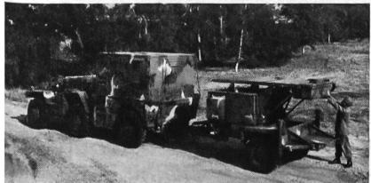
Das amerikanische Radarsystem des Typs AN/TPQ-36 der Firma Hughes Aircraft Company dient zur Ortung schiessender Minenwerfer- und Artillerieschütze. Das System, verlastbar in zwei leichten Modulen, kann mittels Flugzeug oder Heliokopter sehr rasch in das Gefechtsfeld eingeflogen werden oder aber mit Radfahrzeugen (im Bild mit dem 1,25-t-Geländefahrzeug 6x6 «Gama Goat») transportiert werden.
