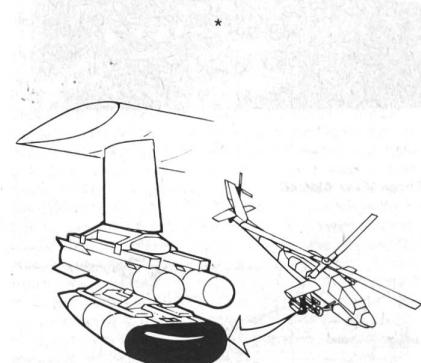
Für die Kampfwertsteigerung des «Advanced Attack Helicopters» AH-64 schlägt Rockwell International ein «Helicopter Adverse-Weather Target Acquisition and Destruction System» (HAWTADS) vor. Dieses auf der Millimeterwellen-Radar-Technologie basierende Waffensystem setzt sich aus den folgenden Komponenten zusammen:
