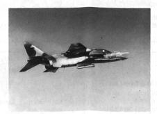
Start einer AS 30L ab einem Jaguar Erdkämpfer während eines Einsatztests. Gut sichtbar ist der elektro-optische ATLIS II-Pod für die Zielauffassung und den Waffenein-
