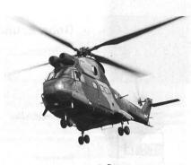
Am 23. Mai 1980 übernahm die RAF den ersten von acht Transporthubschraubern einer verbesserten SA.330 Puma-Version. Die neuen Maschinen unterscheiden sich von den 40 bereits bei der Truppe befindlichen Puma-Einheiten durch verbesserte Lufteinläufe sowie Rotorblätter aus Verbundwerkstoffen. Diese Verbesserungen ermöglichen das Mitführen von zusätzlichen 600 kg Nutzlast (max. Abfluggewicht neu: 7000 kg) und das Fliegen im arktischen Bereich und der Wüste ohne besondere Vorbereitungen.
