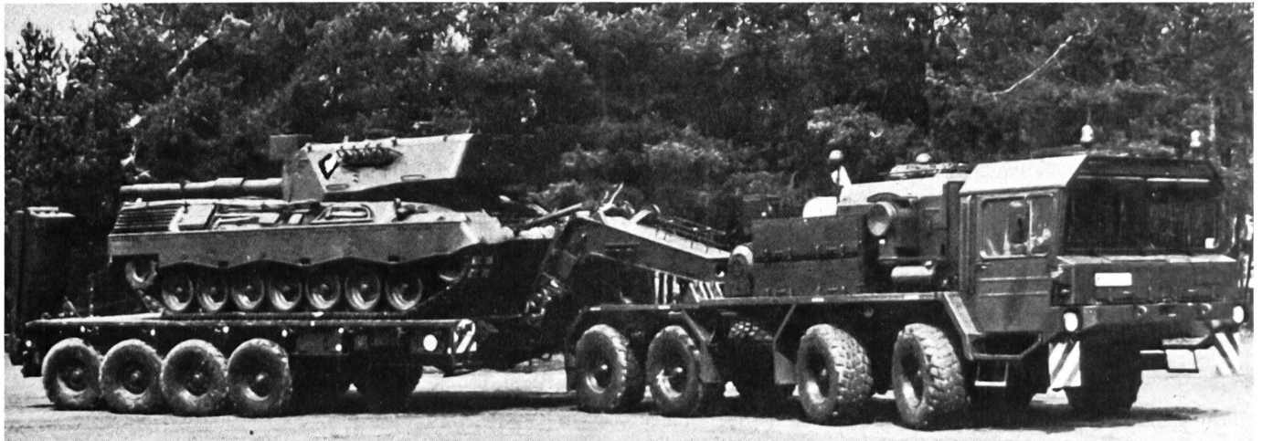
Schwertransport: Zugmaschine mit angehängtem Tiefbettanhänger (darauf ein Kampfpanzer verladen)
