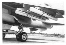
Zwei Hartzielraketenbomben Durandal an den Unterflügellastträgern eines Mirage F.1 Jabos. Bis heute bestellten sechs Länder über 5000 dieser fallverzögerten Abwurfwaffen für den Einsatz aus einem erdnahen Angriffsprofil im Rahmen von «Counter-Air»-Missionen.
