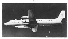
Basierend auf dem Verkehrsflugzeug Iljuschin IL-18 (Nato-Codenamen: Coot) entwickelte die Sowjetunion einen elektronischen Aufklärer. Die auf unserer Foto gezeigte Maschine wurde von einem Piloten der Royal Air Force fotografiert. Sie dürfte neben einer umfangreichen, alle Frequenzbänder überwachenden Detektorenausrüstung auch über eine Seitensichtradaranlage verfügen. ELINT-Apparate dieses Typs operieren u. a. von Luftstützpunkten in der DDR und Polen aus. (ADLG 5/79)
