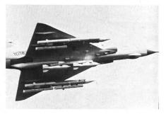
Ein mit 6 Durandal-Startbahnbomben und zwei konventionellen 400-kg-Mehrzweckbomben be-stückter Mirage M5 aufgenommen kurz nach dem Start. Die Durandal verträgt Kampfmarschge-schwindigkeiten bis Mach 1,8 und Beschleuni-
