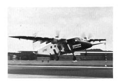
Ein mit einem «Tragflügel Neuer Technologie (TNT)» ausgerüsteter Versuchsträger von Dornier absolvierte am 14. Juni 1979 seinen Jungfernflug. Die Flügelkonstruktion des auf einem STOL-Transporters des Typs Skyservant basierenden Experimentalflugzeugs wurde im Rahmen eines vom Bundesministeriums für Forschung und Tech-nologie geförderten Programms zur Verbesserung der Wirtschaftlichkeit von Flugzeugen entwickelt.
