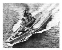
35 000 t, Länge 275 m, Breite 43 m, Tiefgang 8,3 m, Geschwindigkeit 32 Knoten, Besatzung etwa 2500 Mann. Es ist der grösste sowjetische Kriegsschiffstyp unserer Zeit. Die Bewaffnung ist auch imponierend: mehrere Startbehälter für grosse Seezielraketen, Doppelstarter für Fliegerabwehrraketen, Raketen für Nahziel- und U-Bootbekämpfung sowie zahlreiche automatische Universalgeschütze mittleren und kleineren Kalibers. O.B.
