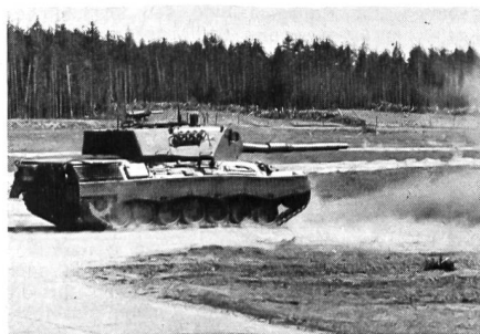
Kampfpanzer Leopard A 4 mit modifiziertem Ketenschutz und Turmaufbau
