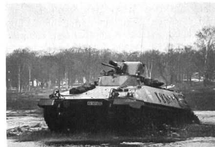
Schützenpanzer Marder – Gefechtsfahrzeug der Panzergrenadiere – mit 20-mm-Bordkanone im Gelände
