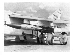
mes der US Navy entstandene Fluggerät flog dabei auf einer Höhe von 10 668 m. Der unter der technischen Leitung des Naval Weapons Center China Lake entstandene STM-Entwurf stellt die Ausgangsbasis für die Entwicklung einer neuen Generation von Luft-Boden-Abstandslenkwaffen dar. Der auf unserer Abbildung an der mittleren Unterflügellaststation eines A-7 Corsair II gezeigte Versuchsträger misst 4,57 m in der Länge und 0,38 m im Durchmesser. Sein Abfluggewicht beträgt 680 kg.
