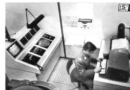
Kommandopult mit TV-Monitor und Drucker für die Auswertung sowie Display für die Programmierung von Übungen.
