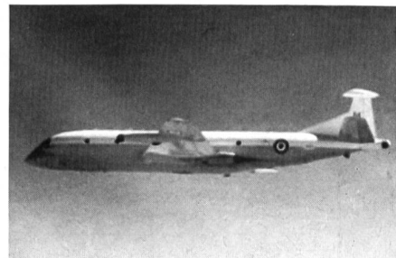
British Aerospace Nimrod R.Mk.1. Elektronikaufklärer der RAF. Basiert auf dem Seeüberwachungs- und U-Boot-Jagdflugzeug Nimrod. Anstelle des Feldstärkesensors (MAD) verfügt diese Maschine über eine im Rumpfheck eingebaute passive Detektoranlage. Drei dieser Apparate werden von der in Wyton beheimateten No 51 Squadron der RAF geflogen.
