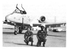
Während des "Air Tattoo" auf der Luftwaffenbasis Greenham Common zeigte die US Air Force erstmals den Erdkämpfer A-10 Thunderbolt II, der speziell zur Bekämpfung von Panzern vorgesehen ist. Unter der Nase ist die Mündung der siebenläufigen Revolverkanone (Gatling-Gun, Kaliber 30 mm) zu erkennen. Demnächst soll auch eine zweisitzige Version dieser Maschine gebaut werden. Man beachte die zur Bodenmannschaft gehörende Mechanikerin Mary Keim.
