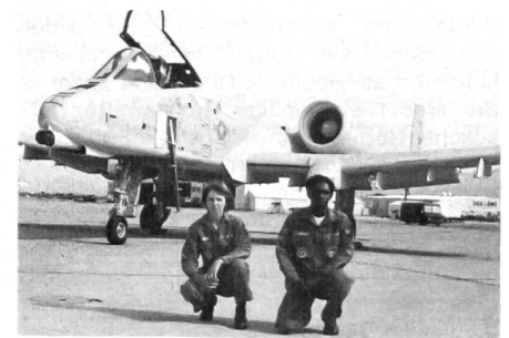
Während des «Air Tattoo» auf der Luftwaffenbasis Greenham Common zeigte die US Air Force erstmals den Erdkämpfer A-10 Thunderbolt II, der speziell zur Bekämpfung von Panzern vorgesehen ist. Unter der Nase ist die Mündung der siebenläufigen Revolverkanone (Gatling-Gun, Kaliber 30 mm) zu erkennen. Demnächst soll auch eine zweisitzige Version dieser Maschine gebaut werden. Man beachte die zur Bodenmannschaft gehörende Mechanikerin Mary Keim.
