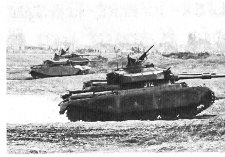
Der Panzer 68 stellt die Weiterentwicklung des Panzers 61 dar. Er enthält wesentliche Verbesserungen und darf als guter Kampfpanzer angesprochen werden.
