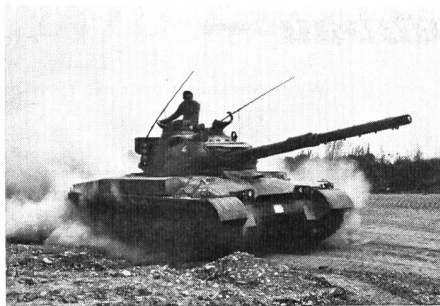
Der in England gekaufte Kampfpanzer Centurion umfasst einen wesentlichen Teil unserer Panzerwaffe. Die ersten Serien waren mit einer Kanone 8,4 cm ausgerüstet und sind seither auf das Kaliber 10,5 cm umgerüstet worden.
