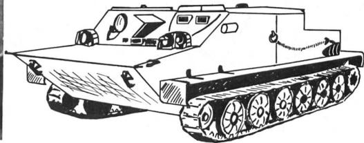
6 Laufräder (vergl. PT-76) mit "Chrysanthemen"-Muster, Seitenwände senkrecht und abgestuft, Bug spitzwinklig (Amphibienfahrzeug) 1 oder 2 Erker in schräger Fahrerfront, neuere Modelle mit ABC-Schutz, Platz für 2 Schützengruppen, Kampf unter Panzerschutz nicht möglich
