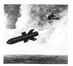
Für die Bekämpfung von See- und Landzielen arbeitet die Division Engins Tactiques von Aerospatiale zurzeit an der Entwicklung einer neuen Luft-Boden-Lenkwaffe. Der für den Einsatz ab Hubschraubern ausgelegte Flugkörper trägt die Bezeichnung Light Anti Surface Semi-automatic Optical und wird mit der Hilfe einer halbautomatischen Infrarotsteuerung ins Ziel gelenkt. Bahnkorrektursignale werden LASSO über Draht
