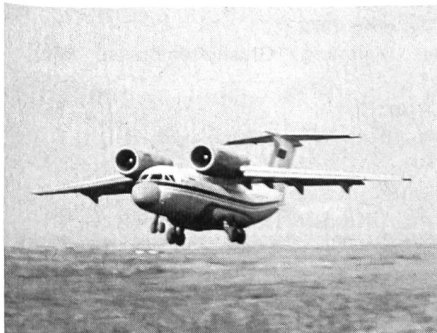
«Coaler» ist der Nato-Codename für den neuen sowjetischen STOL-Kampfzonentransporter AN-72. Dieser anlässlich der Paris Air Show 79 erstmals im Westen gezeigte Hochdecker wird von zwei Mantelstromturbinen Lotarev D-36 von je 6500 kp
