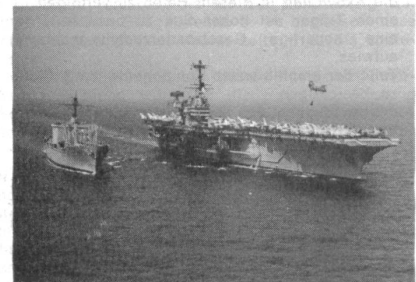
Ol, Lebensmittel und Munition werden auf hoher See während der Fahrt übernommen. Hier fliegt ein Sea-Knight-Helikopter mit Material gefüllte Netze vom Versorgungsschiff «Mars» zum Flugzeugträger «Independence», während die beiden Schiffe im Begriffe sind, die Tragschiffverbindung herzustellen.
