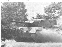
Der Leopard 1 wurde unter allen klimatischen Verhältnissen erfolgreich eingesetzt. Mit den Versionen A 3/4, welche mit moderner Schottpanzerung (etwa 100 % höherer Panzerschutz), der Leopard 1 A4 mit zusätzlich integrierter Feuerleitanlage (ähnlich der des Leopard 2, Laser-E-Messer, stabillisiertes Rundblick-ZF, Elektronenrechner usw.) und automatischem Getriebe ausgerüstet sind, gelang den Konstrukteuren ein beinahe nahtloser Übergang zum Leopard 2.
