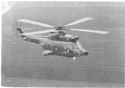
Um die Schlechtwettereinsatzfähigkeit in wetterschwierigen, zur Eisbildung neigenden Atmosphären zu verbessern, modifizierte Aerospatiale ihren Kampfzentransporthubschrauber SA.330 Puma mit zahlreichen Zusatzsystemen. Dazu gehören ein Vereisungsschutz für den Heckrotor, eine Ent-
