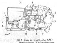
Bild 2 Skizze der einsatzbereiten WFS 1 1 Tragkastenoberteil, 2 Handkolbenpumpe 3 Entlüffungsschlauch, 4 Betriebsmittelbehälter, 5 Trinkwasserbehälter, 6 Reinwasserschlauch, 7 Tragkastenunterteil, 8 Anschwemmfilter, 9 Rohwasserschlauch
