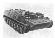
Der Gleiskettentransporter GT-T ist schwimm Gleiskeitendarsprüfer (1717 ist Schminnfähig, hat ein Gewicht von 10 200 kg und erreicht eine Höchstgeschwindigkeit von 45 km/h. Das sehr bewegliche Fahrzeug kann entweder 10 Soldaten oder eine Nutzmasse von 1000 kg befördern
