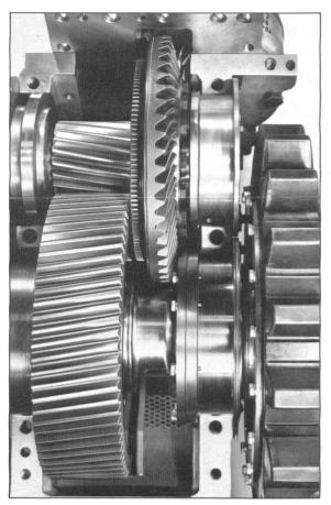
Zweistufiger Achsantrieb mit Umfangfederung für das Triebzahnrad. Dieser Antrieb ist für Bergbahnfahrzeuge mit reinem Zahnradbetrieb bestimmt.
