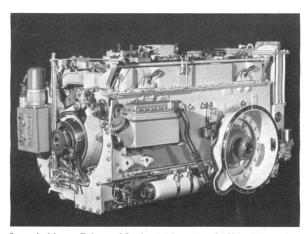
Lastschaltbares Fahr- und Lenkgetriebe mit sechs Vorwärts- und sechs Rückwärtsgängen für schwere Kettenfahrzeuge; übertragene Leistung rund 515 kW.
