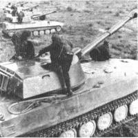
sowjetischen Streitkräften ist unlängst die neue 122-mm-Selbstfahrlafette eingeführt wor-den. Sie besitzt einen drehbaren Turm und ist so konzipiert, dass sie Gewässer schwimmend überwinden kann.
