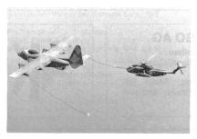
Eine Rettungsmaschine HC-130P Hercules betankt einen bewaffneten Rettungshubschrauber HH-53C Super Jolly. Die Aufgabe des letzteren besteht in der Bergung von über dem Feindgebiet abge-schossenen Flugzeugbesatzungen. ka
