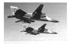
Bis zur Einführung des trinationalen Tornado-Waffensystems sind die zweistrahligen F-111 Schwenkflügler die einzigen allwetterkampffähigen Luftangriffsflugzeuge der NATO.
