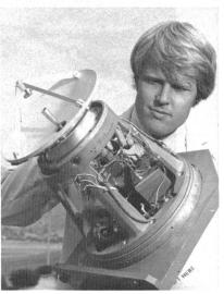
Für die Ausrüstung von Luft-Oberflächen Lenkwaffen der Klasse AGM-65 Maverick und GBU-15 sowie von Copperhead-ähnlichen Geschossen entwickelt die Hughes Aircraft Company einen Millimeterwellen-Zielsuchkopf (94 GHz/M-Band). Diese unter Allwetterbedingungen einsetzbare Lenkeinheit kann wahlweise in einer aktiven und passiven Version gefertigt werden. In ihrer ersten Betriebsart funktioniert sie als Millimeterwellen-
