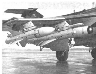
AJ.168 Martel an der inneren Flügelstation eines Tiefangriffsflugzeugs des Typs Buccaneer. Links im Bilde sehen wir einen für die Bekämpfung von Radarstationen ausgelegten Martel-Flugkörper der Ausführung AS37. (ADLG 12/77) ka
