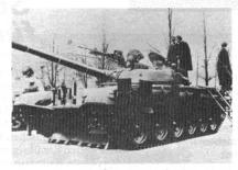
Der Schiessscheinwerfer befindet sich im Gegensatz zum T64 rechts vom Geschütz. Das 4,5 m über die Wannenvorderkante hinausragende 125-mm-Geschütz ist von einer Leichtmetallwärmeschutzhülle umgeben.
