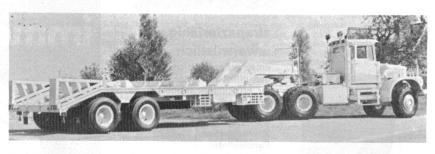
Die USA entwickeln und bauen zur Hauptsache den 75 t schweren Transporter 8×8 M 746/M 747. Max. Höchstleistungsgewicht: 80 000 kp. Die Höchstgeschwindigkeit beträgt 62 km/h, der Strassenfahrbereich 322 km. Höchststeigleistung 15° Wattiefe: 1,2 m, Motor: 608 PS Diesel mit 5 Vorwärts- und 1 Rückwärtsgang.
