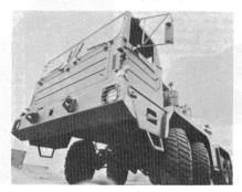
Die Bundeswehr verfügt über den SLT 50-2 von FAUN/Kässbohrer. Das Fahrzeug wiegt 50 t, Zugmaschine 8×8. Es ist strassen- und gelände- sowie watfähig. Das höchstzulässige Totalgewicht beträgt 88 000 kp. Leistungsgewicht ist 8,15 PS/t, Motor: 730 PS Daimler Benz Diesel. Die Höchstgeschwindigkeit ist etwa 65 km/h. Der Fahrbereich beträgt etwa 550 km. Steigleistung etwa 30°.
