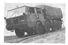
Die sehr moderne Antriebsgruppe setzt sich aus V-12-Dieselmotor, Wechsel- sowie Reduktionsgetriebe zusammen. Drehmomentverteil-, Zwischenachsausgleichsgetriebe und Achsausgleichsgetriebesperren, Zweiachslenkung sowie Reifendruckregelanlage verleihen dem schweren Fahrzeug eine hervorragende Geländegängigkeit.
