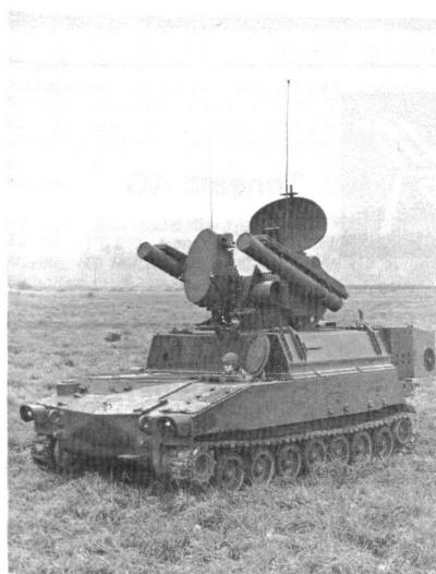
Die erste auf einem Fahrgestell der Panzerhaubitze M-109 aufgebaute Roland Feuereinheit. Das völlig autonome, allwettereinsatzfähige System verfügt über einen Munitionsvorrat von 10 Flugkörpern. Davon befinden sich 2 in Schussposition. Das Nachladen erfolgt automatisch.
