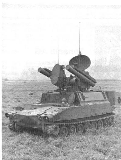
Die erste auf einem Fahrgestell der Panzerhaubitze M-109 aufgebaute Roland Feuereinheit. Das völlig autonome, allwettereinsatzfähige System verfügt über einen Munitionsvorrat von 10 Flugkörpern. Davon befinden sich 2 in Schussposition. Das Nachladen erfolgt automatisch.
