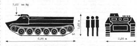
Gewicht 11,9 t / Nutzlast 2 t / Motor (Diesel) 240 PS / Max. Geschw. 61,5 km/h (Land), 6 km/h (Wasser)
