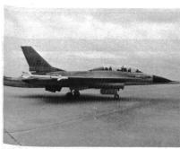
Bereits bei seinem zweiten Flug erreichte der erste Prototyp des doppelsitzigen Einsatztrainers F-16B auf einer Höhe von 9144 m eine Geschwindigkeit von Mach 1,2 und Höchstbelastungen von 7 g. Neben ihrem Einsatz als Schulmaschine für Fortgeschrittene kann die F-16B aber auch als Vollwertiges Kampfflugzeug Verwendung finden.
