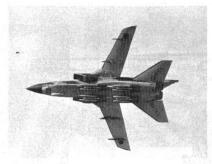
ben. Unsere Foto zeigt den Tornado Prototyp 06 mit acht 454 kg Mehrzweckbomben an den Unter-rumpf-Lastträgern. Gut sichtbar sind auch die vier gegenschwenkenden Unterflügelstationen an den beiden Tragflächen.
