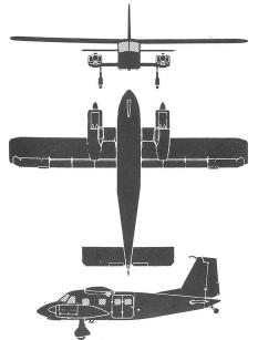
Spannweite 15,50 m / Länge 11,40 m 2 Kolbenmotoren von je 380 PS Reisegeschwindigkeit 240 km/h bis 13 Passagiere
