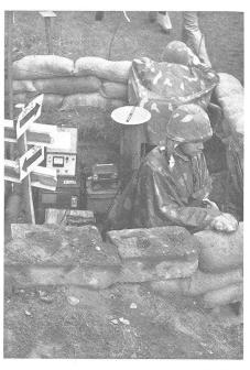
Beobachtungs- und Warnposten des finnischen AC-Schutzdienstes, ausgerüstet mit allen notwendigen Geräten und Instrumenten, um rechtzeitig vor dem Einsatz von Nuklear- oder chemischen Waffen zu warnen, sie festzustellen, Windrichtung und Dosis zu melden.
