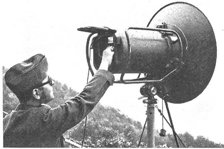
Das Richtstrahlnetz bildet das Hauptverbindungsnetz an der Übung ECHO 77. Unser Bild zeigt ein Gerät R-902 im Einsatz.
