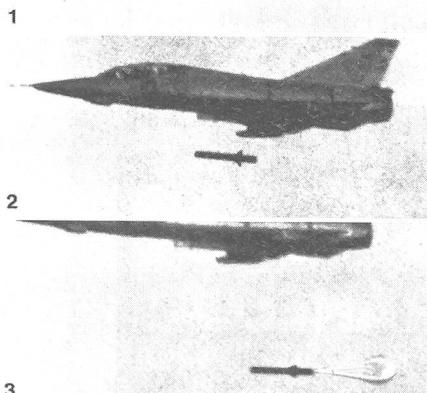
Eine Durandal Attacke wird im schnellen geraden Tiefflug vorgetragen (1). Die Angriffshöhe beträgt dabei mindestens 50 m, und die Geschwindigkeit liegt zwischen 550 und 1110 km/h. Rund 300 m vor dem Ziel wird die Waffe ausgeklinkt (2). Die folgenden Fotos zeigen nun den weiteren Verlauf des Angriffes. Mit der Hilfe eines zweistufigen Bremschirmsystems wird die Bombe abgebremst (3-5). Rund 25 m über Grund zündet der eingegebene Booster und beschleunigt Durandal innerhalb von
