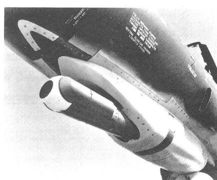
Dieser F-4E Phantom Jagdbomber trägt anstelle einer Gatling-Maschinengunne des Typs M61A1 das Laser Augmented Target Acquisition/Recognition System von Northrop in seinem Geschütz-
