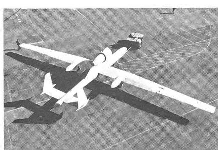
Anlässlich der Luftfahrtsschau in Paris wurden erstmals einige Informationen über die Leistungsfähigkeit des bei der Boeing Company in Entwicklung stehenden Compass Cope Fernlenkflugzeugs bekannt. Zurzeit arbeitet Boeing im Rahmen eines im August 1976 gewonnenen USAF-Auftrages an drei Prototypen dieses allwetter-einsatzfähigen Langstrecken-Höhenaufklärungs-
