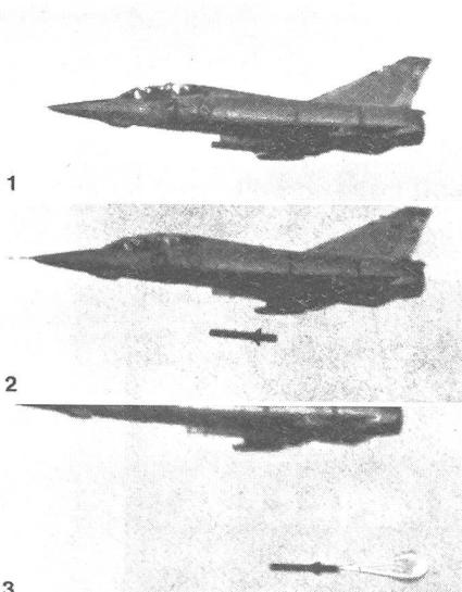
Eine Durandal Attacke wird im schnellen geraden Tiefflug vorgetragen (1). Die Angriffshöhe beträgt dabei mindestens 50 m, und die Geschwindigkeit liegt zwischen 550 und 1110 km/h. Rund 300 m vor dem Ziel wird die Waffe ausgeklinkt (2). Die folgenden Fotos zeigen nun den weiteren Verlauf des Angriffes. Mit der Hilfe eines zweistufigen Bremschirmsystems wird die Bombe abgebremst (3-5). Rund 25 m über Grund zündet der eingegebene Booster und beschleunigt Durandal innerhalb von
