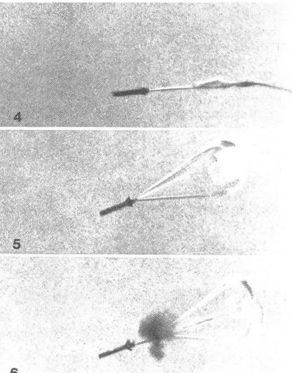
0,4 s von einer Fallgeschwindigkeit von 20 m/s auf 200 m/s (6). Diese Brennschlussgeschwindigkeit reicht aus, um bis zu 40 (+) cm Beton zu durchschlagen. Nach dem Eindringen gelangt der rund 100 kg schwere Gefechtskopf zur Explosion. Dabei wird 150 bis 200 m<sup>2</sup> Piste aufgeworfen, und es entsteht ein Krater von 5 m Durchmesser und 2 m Tiefe. Herstellerangaben zufolge sollen sechs Durandal-Hartszielraketenbomben ausreichen, um eine Standardpiste mit den Abmessungen 60 ×
