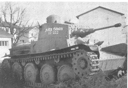
Panzerung: — Turm vorn 30 mm, Seite 20 mm — Wanne vorn 30 mm, Seite 20 mm, hinten 15 mm Besatzung: 3 Mann Abmessungen: Länge: 4,8 m; Breite: 2,2 m; Gewicht: 13 t
