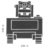
Baujahr 1959 (Fahrgestell M 113 A 1) und 1977 (Raketenwerfer TOW) / Gewicht 11,5 t Motor (Diesel) 215 PS / Maximale Geschwindigkeit 65 km/h
