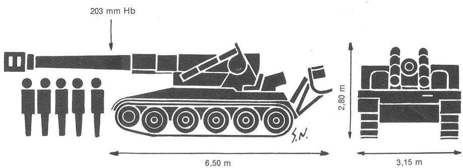
Baujahr 1962 (Fahrzeug), 1977 (Geschütz) / Gewicht etwa 30 t / Motor 420 PS / Max. Geschw. 55 km/h
