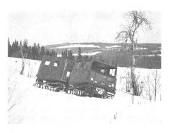
Das bei der Firma AB Hägglund & Söner in Ornskoldvik in Nordschweden entwickelte «Oversnow vehicle» Bv 206 ist voll geländegångig bei einer Nutzlast von 2 t. Der Antrieb erfolgt über einen V-6-Benzinmotor von 138 PS und Zentralantrieb auf beide Gummiketten-Gruppen. Das Fahrzeug wird als Panzerabwehrfahrzeug für die Panzerabwehrlenkwaffe TOW mit Mannschafts- und Munitionsanhänger, als Reparaturfahrzeug, Feuerlöschfahrzeug, Munitionslaster sowie als Truppentransportfahrzeug verwendet.
