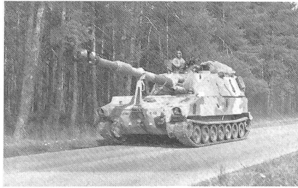
Eine Panzerhaubitze M-109 A 1 der 1. US-Panzerdivision (Manöverpartei BLAU) auf dem Marsch (Kaliber des Geschützes 155 mm, Schussweite etwa 18 km, Gewicht 24,1 t).
