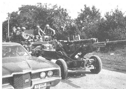
Eine Artillerieeinheit der 101. Air Assault Division auf dem Vormarsch. Ausnahmsweise werden die 10,5-cm-Haubitzen des Typs M-102 hier nicht auf dem Luftwege transportiert, sondern von den Geländefahrzeugen M-561 Gama Goat gezogen. Die M-102-Haubitze zeichnet sich durch die grosse Bodenplatte aus, die das rasche Rundumschwenken ermöglicht.
