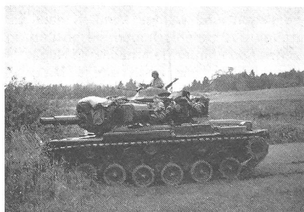
Nach vergeblichen Versuchen, auf der nassen, glitschigen Wiese einen leichten Hang zu meistern, hat sich dieser Panzer des Typs M 60 A 2 hinter einer Hecke notdürftig versteckt. Er gehörte zu den vordersten Elementen des 2. US-Panzeraufklärungsregiments der Manöverpartei BLAU. Das Rohr vom Kaliber 152 mm ermöglicht das Verschießen von Granaten wie auch von Flugkörpern des Typs Shillelagh.
