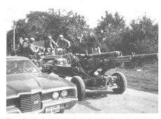
Eine Artillerieeinheit der 101. Air Assault Division auf dem Vormarsch. Ausnahmsweise werden die 10,5-cm-Haubitzen des Typs M-102 hier nicht auf dem Luftwege transportiert, sondern von den Geländefahrzeugen M-561 Gama Goat gezogen. Die M-102-Haubitze zeichnet sich durch die grosse Bodenplatte aus, die das rasche Rundumschwenken ermöglicht.
