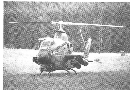
Das Hauptkampfmittel der 101. Air Assault Division: die AH-1 G Cobra, ein Helikopter zur Bekämpfung von Panzern. Hier ist eine solche Maschine auf einer improvisierten Basis gelandet und wartet den nächsten Einsatzbefehl ab. Beachte die seitlich angebrachten Behälter für je 19 Raketen (ungelenkt, 70 mm) sowie das unter der Nase angebrachte schwenkbare Mg (7,62 mm) und den 40-mm-Granatwerfer.
