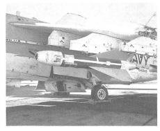
Im Rahmen einer Vorserienproduktion wird bei der Avionic Facility Indianapolis der US Navy zurzeit ein Modifikationsprogramm für die bei der Truppe im Dienste stehenden Gleitbomben des Typs AGM-62 Walleye geprüft. Die Arbeiten an der fernsehgesteuerten Abwurfwaffe umfassen den Einbau von grösseren Steuerflächen und einer Datenübertragungseinrichtung. Diese Verbesserungen sollen in erster Linie die heutige Reichweite der Walleye von rund 45 km vergrössern. Die AGM-62
