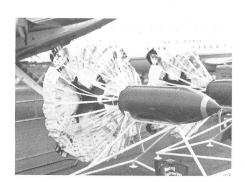
Um Erdkampfflugzeugen den Angriff im schnellen geraden Tiefflug (30 bis 120 m) mit ungelenkten Bomben zu ermöglichen, entwickelte das britische Unternehmen Hunting Engineering Limited eine Fallverzögerungseinrichtung für Abwurfwaffen. Dieses für die Bestückung von britischer und amerikanischer 227-454 kg Munition ausgelegte Bremssystem verzögert den Fall und damit die Detonation von Abwurfwaffen so lange, bis das Trägerflugzeug den Wirkungsbereich der Bombe verlassen hat.
