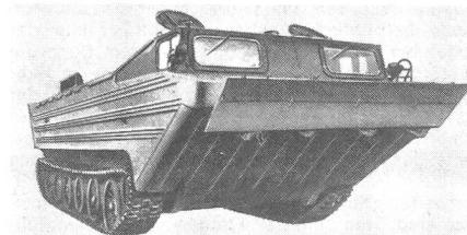
Dieser Schwimmwagen wird verwendet zum Übersetzen von Schützeinheiten bis zu 70 Mann, von Geschützen und Kraftfahrzeugen. Er ist nützlich beim Bau von Anlande-, Fähren- und Brückenübersetzstellen und auch bei Taucherarbeiten. Masse: 17 700 kg Gewicht, 11,5 m Länge, 3 m Breite, 2,65 m Höhe. Im Wasser beträgt die Fahrgeschwindigkeit mit 10 t Nutzlast und 2 Mann Besatzung 10 km/h.
