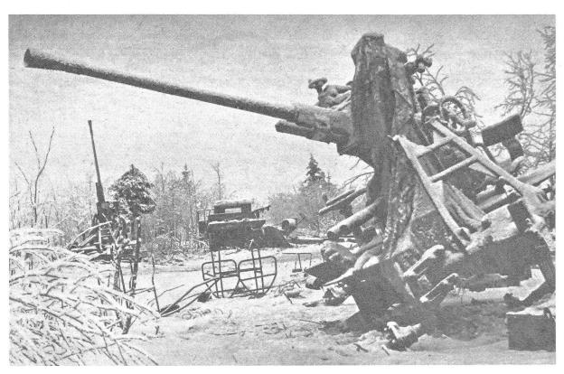
Nach dem Kampf. Verlassenes russisches Material: Flab-Maschinenkanone 37 mm, Reichweite gegen Luftziele bis 2000 m, Feuergeschwindigkeit 180 Schuss/Minute, Vo 895 m/Sek, Geschossgewicht 725 g, Gewicht in Feuerstellung 1950 kg, 4-Rad-Lafette, durch Last-
