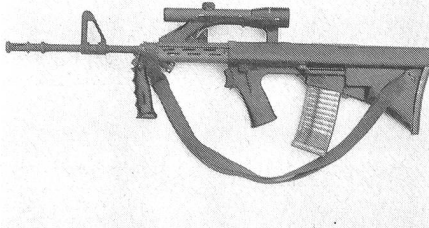
Das Sturmgewehr 77 (Stg 77) mit optischer Zieleinrichtung. Es wiegt nur 3,3 kg und hat eine Gesamtlänge von 79 cm.
