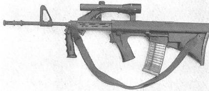
Das Sturmgewehr 77 (Stg 77) mit optischer Zieleinrichtung. Es wiegt nur 3,3 kg und hat eine Gesamtlänge von 79 cm.
