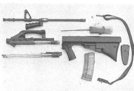
Das Stg 77, das in der Hauptsache aus Kunststoff hergestellt wird, kann ohne Werkzeug zerlegt und zum grössten Teil mit Wasser gereinigt werden.
