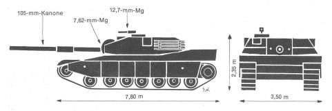
Baujahr 1975 (Prototyp) 1979 (Vorserie) / Gewicht 52,6 t / Motor (Gasturbine) 1500 PS / Max. Gesch. 72 km/h
