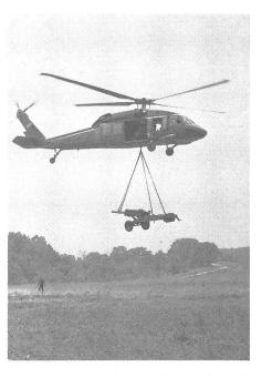
Leistung angetriebene YUH-60A folgende Geschwindigkeiten und Höhen: 272 km/h bei einem Abfluggewicht von 9070 kg, 319 km/h Höchstgeschwindigkeit auf Meereshöhe und eine Gipfelhöhe von 5955 m. Für den UTTAS-Drehflügler hat das amerikanische Heer einen Bedarf von über 1000 Einheiten angemeldet.
