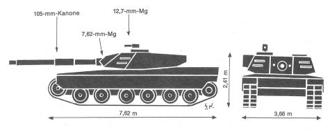
Baujahr 1975 / Gewicht 52,6 t / Motor (Diesel) 1500 PS / Max. Geschw. 77 km/h
