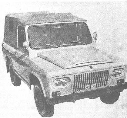
Ein neuer, leichter und geländegängiger PKW für Personen- und Materialtransporte wurde unlängst in den rumänischen Streitkräften eingeführt. Es handelt sich bei diesem Fahrzeug um eine im Lande entwickelte Konstruktion mit der Bezeichnung PKW ARO 240. Der Wagen hat eine Nutzlast von 700 kg, entwickelt eine Höchstgeschwindigkeit von 110 km/h, besitzt einen Fahrbereich von 500 km bei einem Tankvolumen von 95 l und entwickelt eine Steigungsfähigkeit von 35 Grad.
