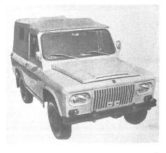
Ein neuer, leichter und geländegängiger PKW für Personen- und Materialtransporte wurde unlängst in den rumänischen Streitkräften eingeführt. Es handelt sich bei diesem Fahrzeug um eine im Lande entwickelte Konstruktion mit der Bezeichnung PKW ARO 240. Der Wagen hat eine Nutzlast von 700 kg, entwickelt eine Höchstgeschwindigkeit von 110 km/h, besitzt einen Fahrbereich von 500 km bei einem Tankvolumen von 95 I und entwickelt eine Steigfähigkeit von 35 Grad.
