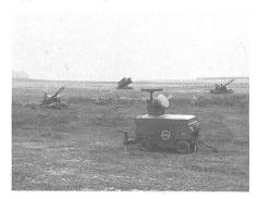
Skyguard-Feuereinheit mit 35-mm-Flabkanone und Sparrow-Raketenwerfer
