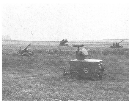
Skyguard-Feuereinheit mit 35-mm-Flabkanone und Sparrow-Raketenwerfer
