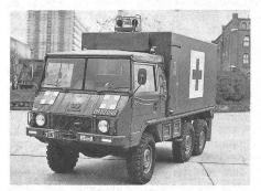
Steyr-Pinzgauer-Geländefahrzeug mit Sanitätsaufbau
