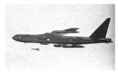
Eine fernsehgesteuerte GBU-15/EOGB 2, nommen kurz nach ihrem Abwurf. Die Einsatz-steuerung wird vom Navigator des B-52 Trägerflugzeugs über die integrierten Datenübermitt-lungseinrichtungen vorgenommen. Der Gefechts-kopf besteht aus einer 907 kg Mehrzweckbombe.
