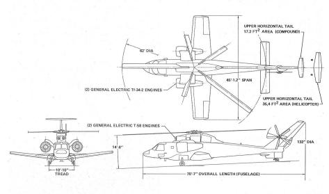
US Army-NASA/Sikorsky Aircraft Verbundhubschrauber Versuchsträger S-72 (ADLG 11/76)
